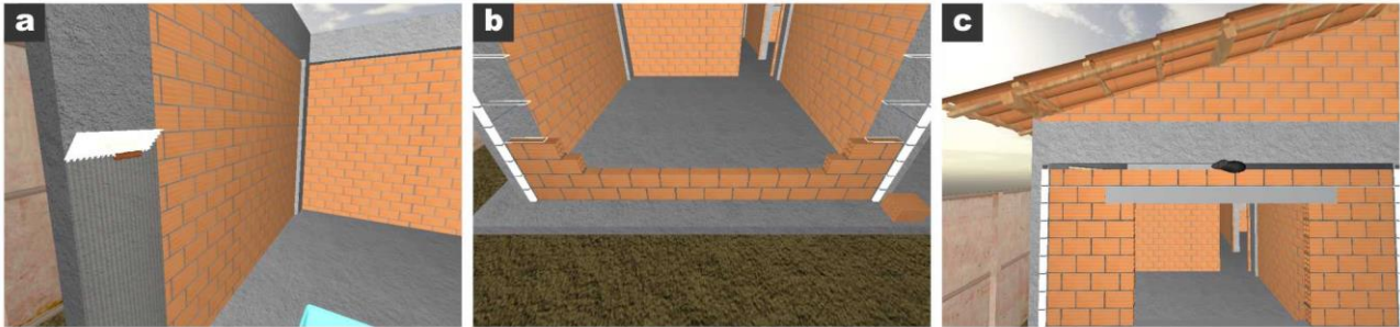
Figura 2: Passos realizados pelo ALVI para a execução da alvenaria.
